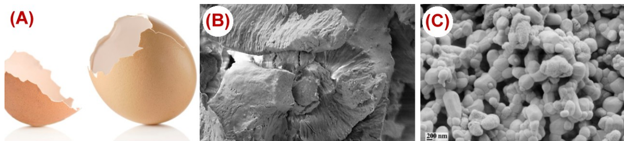
2. ábra. Hidroxiapatit és forrása: (A): tojánhéj, (B): kiégetett tojánhéj (elektronmikroszkópos kép), (C): HAp por (elektronmikroszkópos kép) [11]
